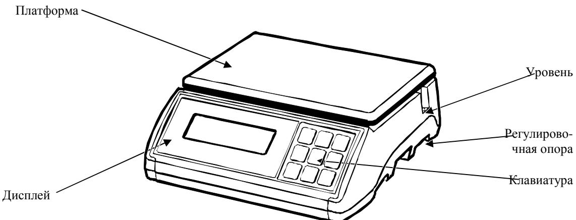
В днище весов с правой стороны имеется кнопка питания ВКЛ./ВЫКЛ. и гнездо для адаптерного штекера, а с левой стороны – интерфейсный разъем RS-232C; по центру днища расположена аккумуляторный отсек и перед ним – планка с 2 пломбировочными винтами, закрывающая доступ к юстировочной кнопке.
